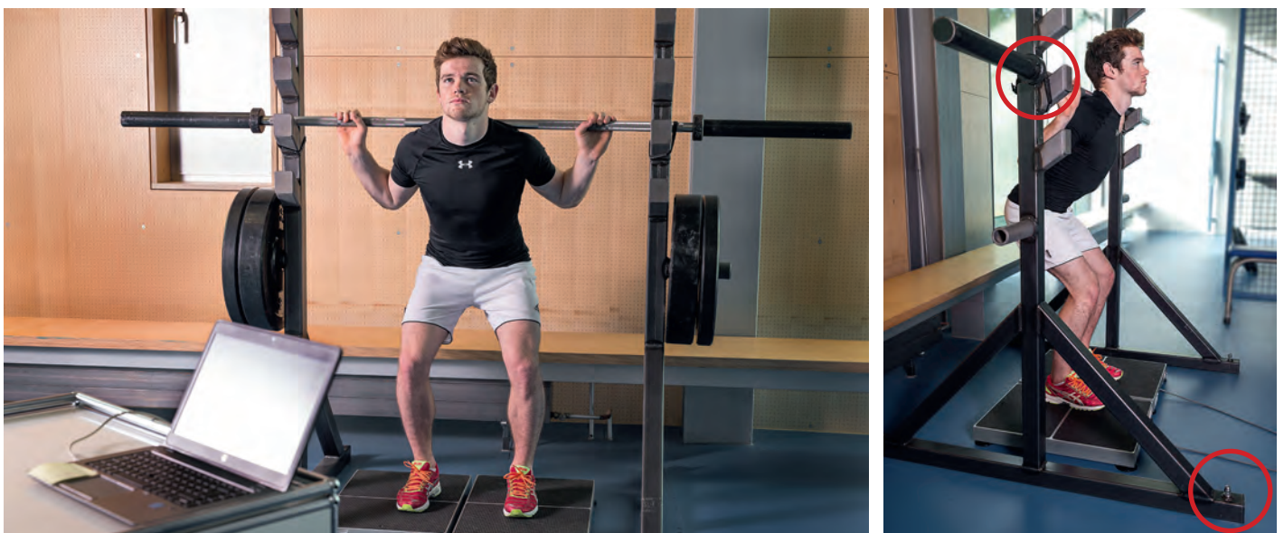
Abbildung 4–2. Ausführungsposition beim Test der beidbeinigen isometrischen Maximalkraft in der Kniebeugenstellung. Der Kniebeugenständer ist am Boden fixiert und die Hantelstange mit dem Kniebeugenständer fest verbunden (rot umkreist).
