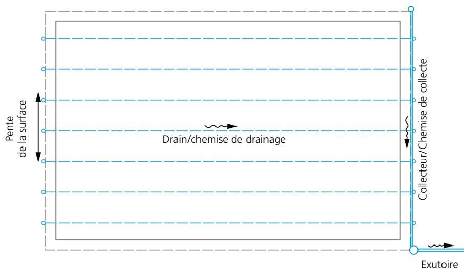
Fig. 6: Configuration du drainage pour une construction avec drainage de surface.
