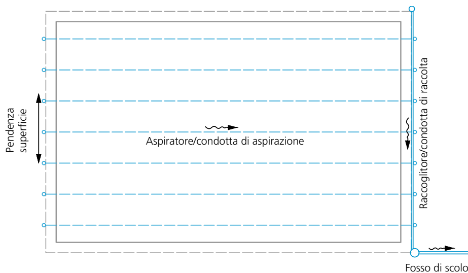
Fig. 6: Disposizione delle installazioni di smaltimento delle acque per i sistemi di costruzione con drenaggio superficiale
