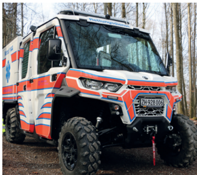
Die Frontansicht mit dem hohen Radstand und den grobstolligen Reifen macht klar, auf welchem Terrain das ATV primär zum Einsatz kommt.
